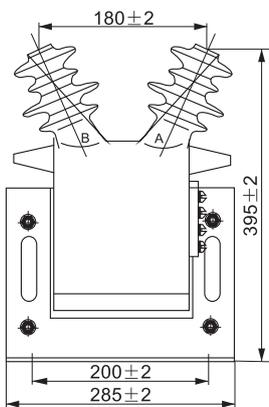
**JDZC10-3,6,10(DC-3,6,10) 型讯号电压互感器****JDZC10-3,6,10(DC-3,6,10) Signal voltage transformer type****概述 Description**
